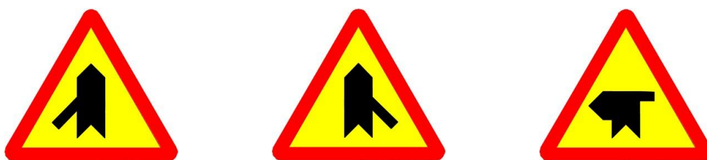
a) Biển số W.207f b) Biển số W.207g c) Biển số W.207h
