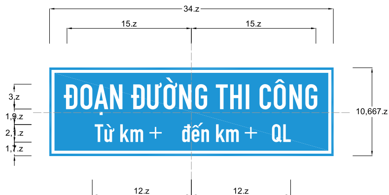
Biển số I.440 : Đường đang thi công
