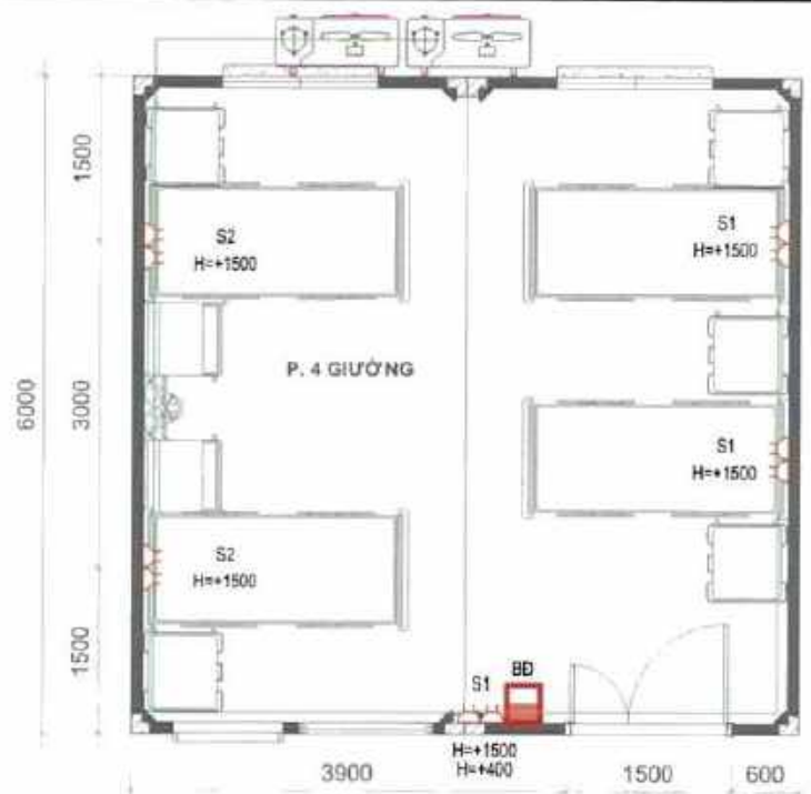
MẶT BẰNG CẤP ĐIỆN
