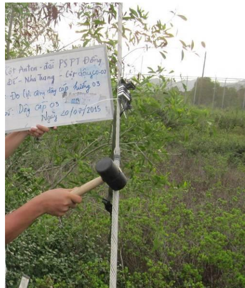
Hình 8.3 - Kích thích dao động bằng búa cao su
