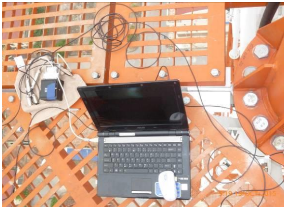
Hình 9.3 - Bố trí các thiết bị đo dao động
