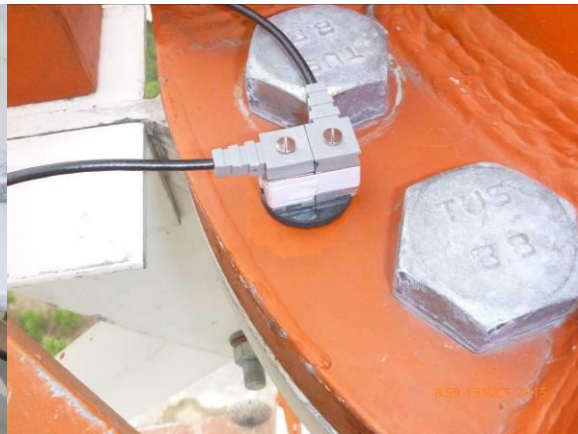
Hình 9.2 - Bố trí đầu đo dao động trên mặt bích nối đốt thanh cánh
