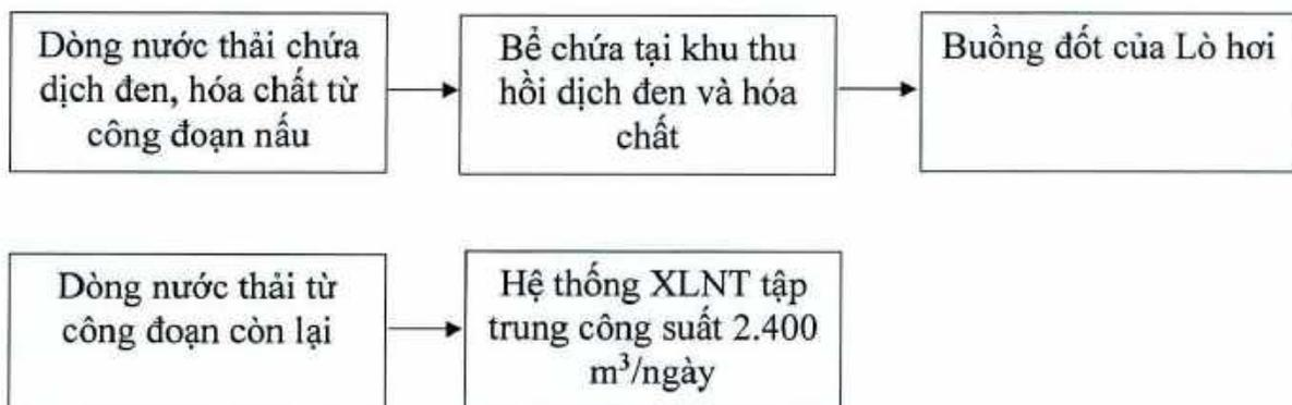
Nước thải sản xuất được tách làm 02 dòng nước thải riêng biệt bao gồm 01 dòng nước thải chứa dịch đen và hóa chất phát sinh từ quá trình nấu tại nồi nấu
