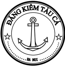
Quy cách: Dấu hình tròn, có 03 vòng tròn đồng tâm: vòng tròn 1 có đường kính 35 mm, bề dày 0,2 mm; vòng tròn 2 cách vòng tròn 1 (về phía trong) bằng 0,5 mm, có bề dày 0,1 mm; vòng tròn 3 cách vòng tròn 2 (về phía trong) bằng 4 mm, có bề dày 0,1 mm; ở giữa là hình neo hải quân; giữa vòng tròn 2 và 3 có dòng chữ “ĐĂNG KIỂM TÀU CÁ” ở phía trên và tên cơ sở đăng kiểm ở phía dưới bằng tiếng Việt, phong chữ Times New Roman cỡ 10.
