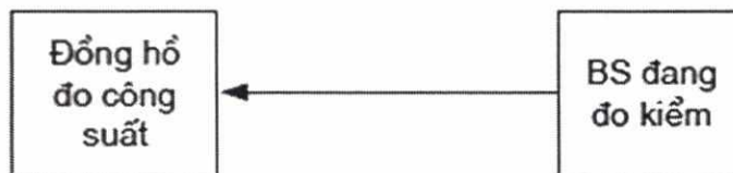
Hình D.3 - Sơ đồ đo công suất ra cực đại của trạm gốc
