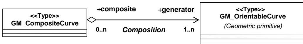
Hình C.22. Lược đồ lớp GM_CompositeCurve
