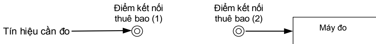
Hình 3- Sơ đồ đo độ cách ly giữa điểm kết nối thuê bao (1) với điểm kết nối thuê bao (2) trong một hộ gia đình
