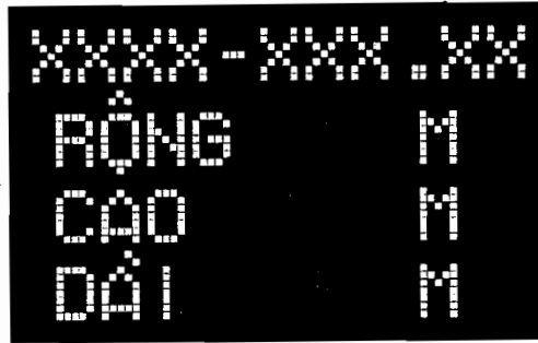
Hình 17. Ví dụ về biển báo VMS thông báo kích thước đo được của xe gắn với biển số xe (XXXX-XXX.XX là biển số xe)
