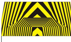
Hình G.27 -Vạch chỉ dẫn ở trạm thu phí
