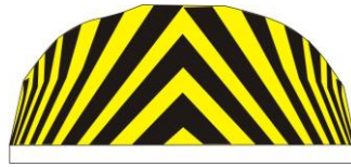
Hình G.29 -Vạch chỉ dẫn ở trạm thu phí
