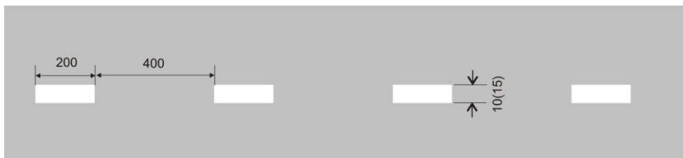
Hình G.3 -Vạch số 3: Vạch phân chia các làn xe, đơn vị cm
