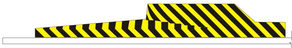
Hình G.26 -Vạch chỉ dẫn ở trạm thu phí
