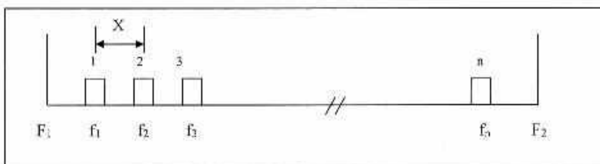
Hình 1.1. Sơ đồ phân kênh đối với truyền dẫn một tần số
