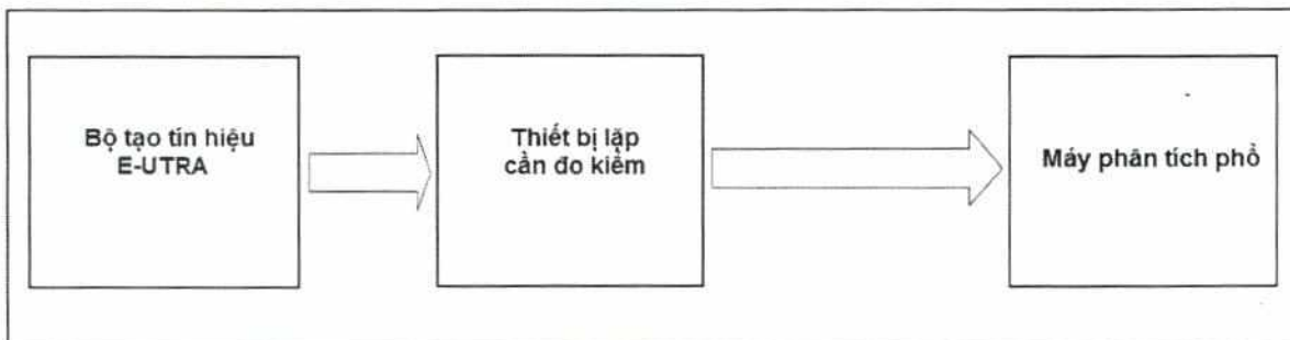
Hình C. 3 – Sơ đồ đo phát xạ không mong muốn: Phát xạ không mong muốn băng tần hoạt động
