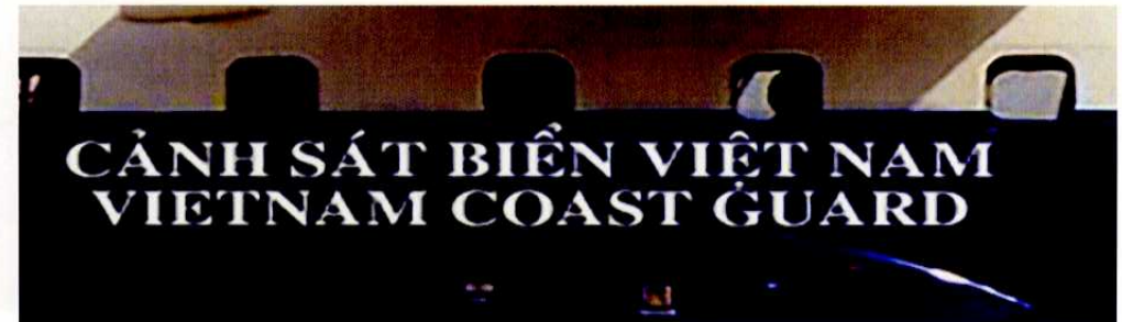
Vị trí giữa thân máy bay (hai bên) sơn dấu hiệu nhận biết tên Cảnh sát biển bằng tiếng Việt Nam và tiếng Anh.
