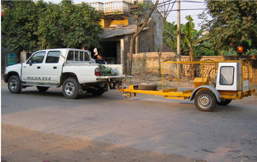
Hình 4. Thiết bị FWD được một ô tô kéo đi khi di chuyển và đo đạc
