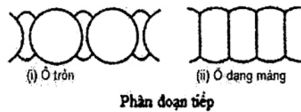
Hình 16 - Công trình kiểu ô vây tường cọc ván điển hình
