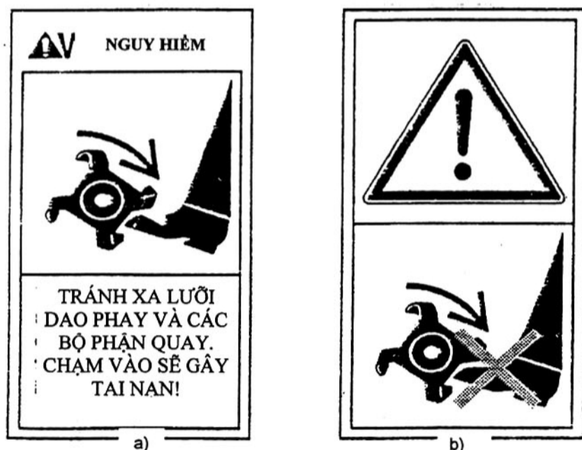
Hình 7- Minh họa nhãn cảnh báo an toàn đối với phay/lưỡi dao phay
