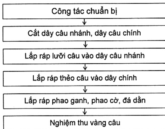
Hình B.1. Sơ đồ quy trình kỹ thuật lắp ráp vàng câu
