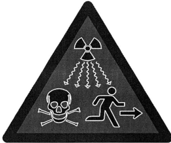
Hình 2: Dấu hiệu cảnh báo bức xạ ion hóa bổ sung sử dụng cho các nguồn phóng xạ thuộc mức an ninh A, B và C
