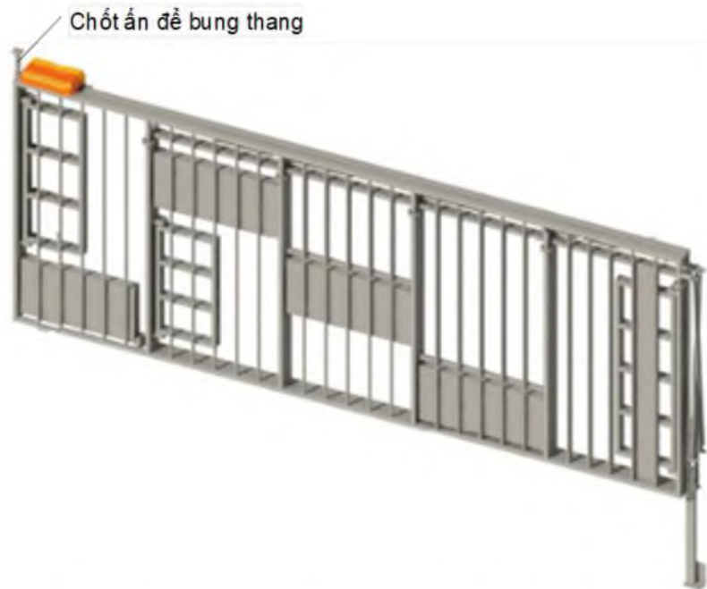
Hình B.16 – Ví dụ minh họa thang thoát nạn khẩn cấp tích hợp lan can tự hạ ở mặt ngoài nhà (trạng thái đóng của một phân đoạn thang trong phạm vi 1 tầng)
