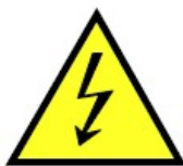
Hình 1 – Cảnh báo nguy hiểm điện áp cao
