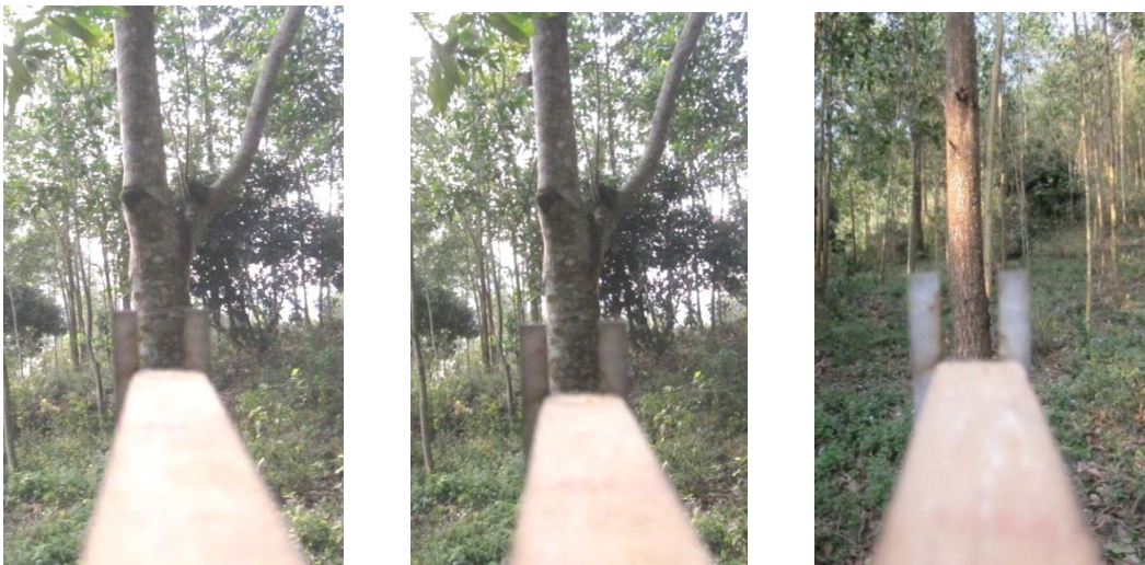
Hình ảnh. Quay thước Bitteclich để xác định tổng tiết diện ngang của lâm phần (Từ trái qua phải: 1: Cắt hoàn toàn, 2: Tiếp tuyến, 3: Lọt hoàn toàn)
