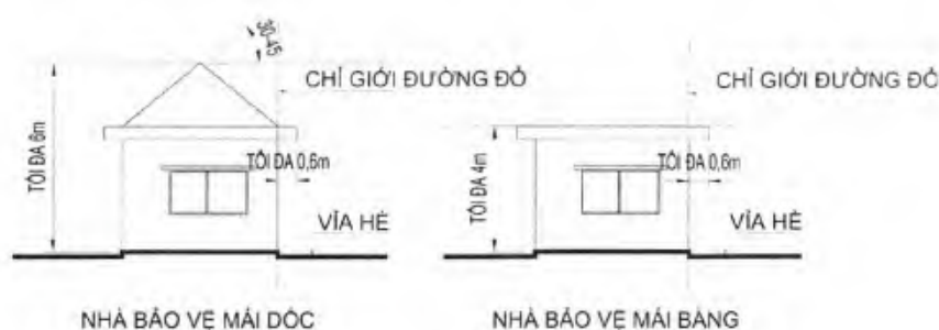
Hình 9-1: Mặt cắt công trình phụ
