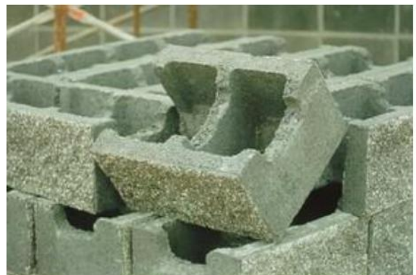
Hình 43 – Tường chống ồn: khối xây (minh họa)
