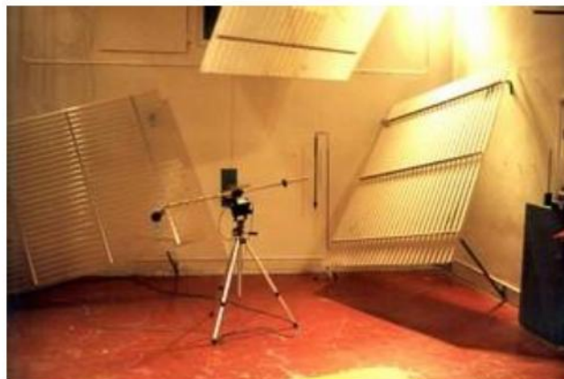
Hình 12 – Hấp thụ của tường chống ồn: Phương pháp phòng dội âm ASTM C423 (minh họa)
