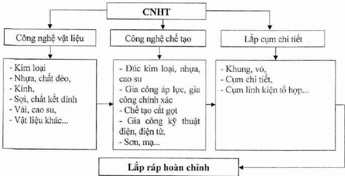
Sơ đồ 1: Quy trình công nghệ sản xuất sản phẩm điện tử, tin học, viễn thông
