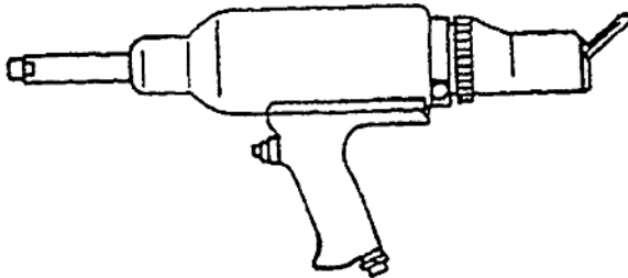
Hình B.3 – Máy cầm tay tán đinh bằng đầu tán
