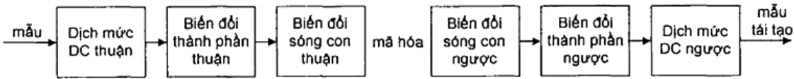
Hình G.1 - Vị trí của dịch mức DC với biến đổi thành phần
