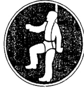
Đeo dây an toàn (M09)
