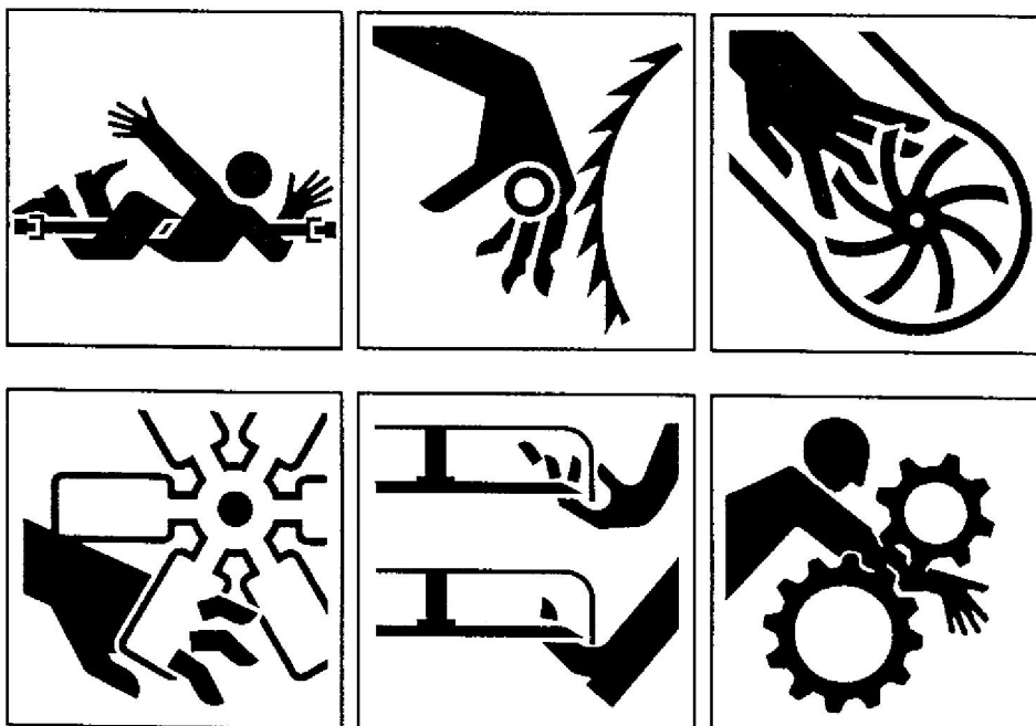
Hình D.17 - Các mẫu hình vẽ trình bày nguy hiểm riêng biệt do các bộ phận máy gây nên
