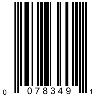
Hình 4 - Mã vạch UPC-E (mã hóa “0 07834 00009 1” bằng cách nén số 0)
