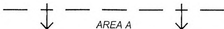
Hình 19 — Ký hiệu ví dụ: ký hiệu đường phức hợp với biểu tượng điểm mỏ neo lặp lại dọc theo đường ký hiệu ranh giới một vùng đậu tàu
