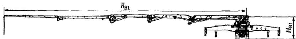
Hình 10 – Đo chiều cao lớn nhất của cần phân phối bê tông
