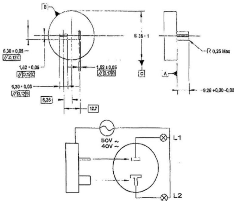
Dưỡng khi cắm hoàn toàn theo hướng vuông góc với mặt tiếp giáp của ổ cắm không được làm cho bóng đèn L1 hoặc L2 sáng.
