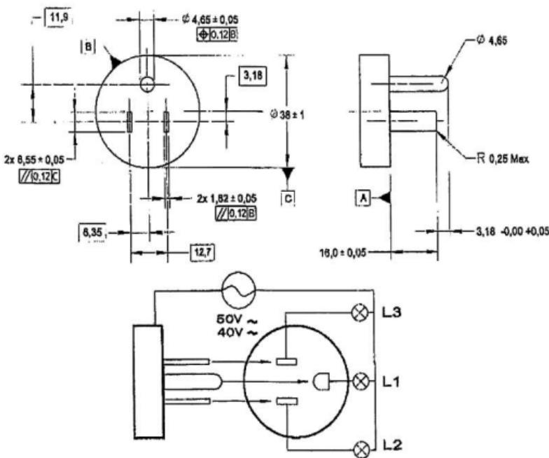
Dưỡng khi cắm hoàn toàn theo hướng vuông góc với mặt tiếp giáp của ỗ cắm phải làm cho bóng đèn L1, L2 và L3 sáng.
