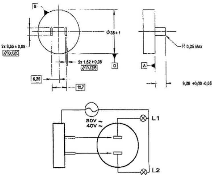
Dưỡng khi cầm hoàn toàn theo hướng vuông góc với mặt tiếp giáp của ỗ cắm không được làm cho bóng đèn L1 hoặc L2 sáng.
