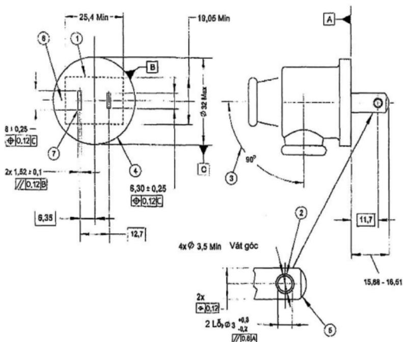
Phích cắm hai cực có phân cực (không thẻ đảo cực) được phép sử dụng khi có yêu cầu sự phân cực của đầu nối mạch điện.
