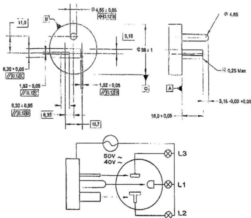
Dưỡng khi cắm hoàn toàn theo hướng vuông góc với mặt tiếp giáp của Ổ cắm phải làm cho bóng đèn L1, L2 và L3 sáng.
