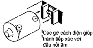
Hình B.2b – Lắp ngược pin
