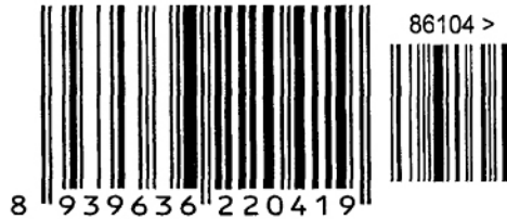
Hình 6 - Mã vạch EAN-13 với mã vạch bổ sung 5 chữ số.
