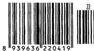
Hình 5 - Mã vạch UPC-A cùng với mã vạch phụ 2 chữ số
