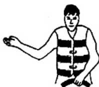
Hình 5 – Rẽ phải: chỉ về phía bên phải thiết bị được kéo
