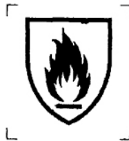
Hình 1 – Ví dụ về quần áo bảo vệ chống nóng và lửa (ISO 7000-2471)
